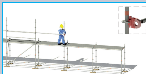
Rail de guidage de garde-corp horizontaux (bloc coulissant en plastique avec tête à clavette).
