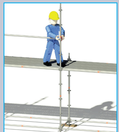
Rail de guidage de garde-corp horizontaux (bloc coulissant en plastique avec tête à clavette).
